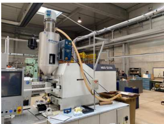
Système d'aspiration de la matière plastique brute
