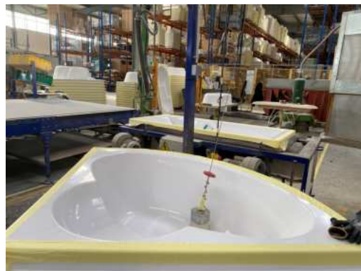
Palan pour installer les poids de calibrage de sortie de baignoire
