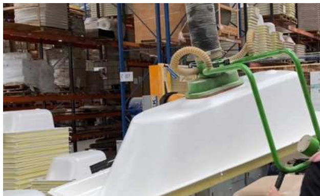
Bras manipulateur à ventouse pour déplacer facilement les baignoires.
